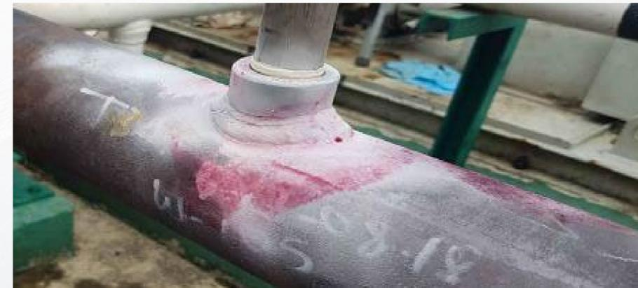
Verificación de proceso de soldadura por tintas penetrantes
